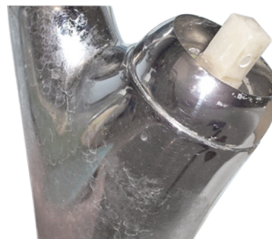
Смеситель из ZAMAKа. Хорошо видны дефекты хром-никелевого покрытия.
